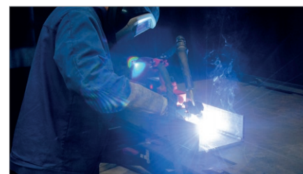
Schweißen in engen Räumen (min. Breite 200 mm)
