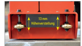
Höhenverstellbare Führungsrollen in einem Bereich von 13 mm
