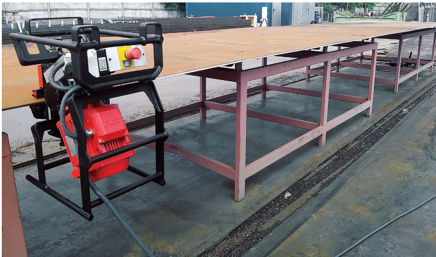
La smussatrice ABM-14 avanza automaticamente lungo la lastra
