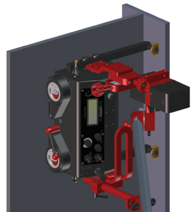
Kehlnaht-Schweißen mit Oszillator
