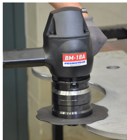
Creazione di un raggio perfetto su entrambi i bordi con profili rettilinei e curvi
