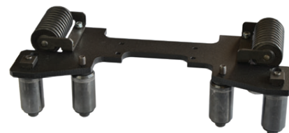
Attacco per la smussatura di lastre rotonde: Raggio esterno minimo R = 1000 mm (40") Raggio interno minimo R = 1000 mm (40") Larghezza max di smusso 19 mm Codice prodotto: ZSP-0539-10-00-00-0
