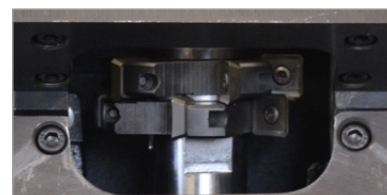
2 teste di fresatura rotanti, ciascuna contenente cinque inserti intercambiabili a 4 taglienti
