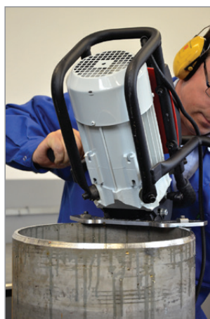
Biselado de tuberías
