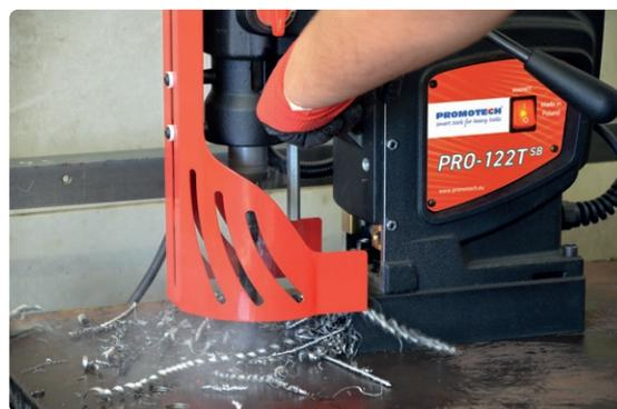
Foratura con punte elicoidali max 31.75 mm (1-1/4")
