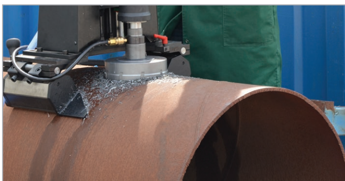
Il modello PRO-200A ATEX può essere fissato su tubi di diametro min 950 mm (37,4")
