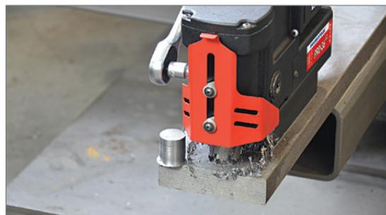
Capacità max di fresatura fino a 36 mm (1-7/16")
