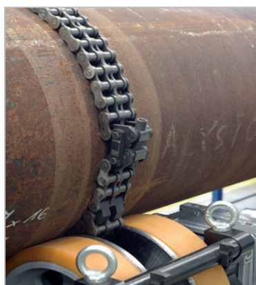
La catena regolabile (ø200 - 1000mm) assicura una rotazione assiale positiva
