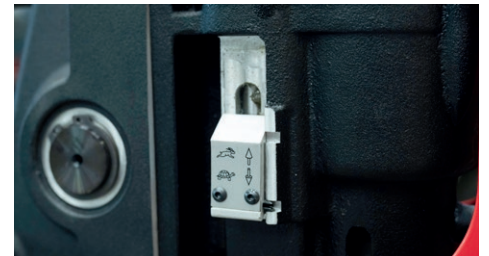
Riduzione giri a 2 marce per ottimizzare la velocità dell'utensile
