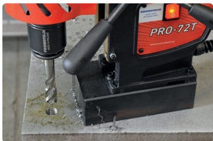
Maschiatura fori passanti sino a M20
