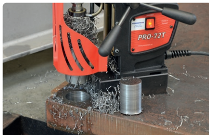
Foratura con frese a corona sino a 70 mm • Profondità max. sino a 75 mm
