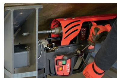
Capacità di foratura con punte elicoidali sino a 25 mm. Design leggero di soli 18 kg.
