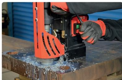
Capacità di foratura con frese a corona sino a 70 mm
