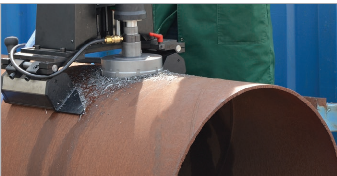
PRO-200A ATEX kann an Rohren mit min. Durchmesser von 950 mm befestigt werden
