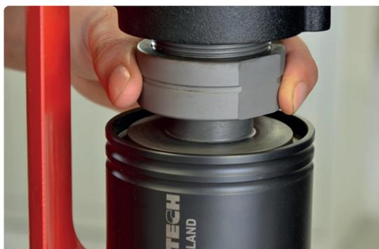
Das Gewindegewindeschneidfutter mit Sicherungsmutter schützt das Gewindegewindeschneidwerkzeug gegen Herausziehen
