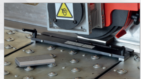
Führung für kleine Werkstücke
