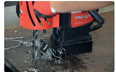
Bohrleistung bis zu 23 mm • Max. Hub bis zu 190 mm
