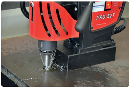
Durchgangsgewindebohren bis M20
