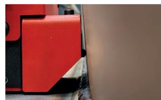
Blindage spécialement conçu avec une contre-dépouille qui facilite le soudage multipasse et réduit considérablement le risque de collision.
