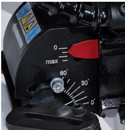
Ajuste del ángulo continuo de 0 a 60 grados.
