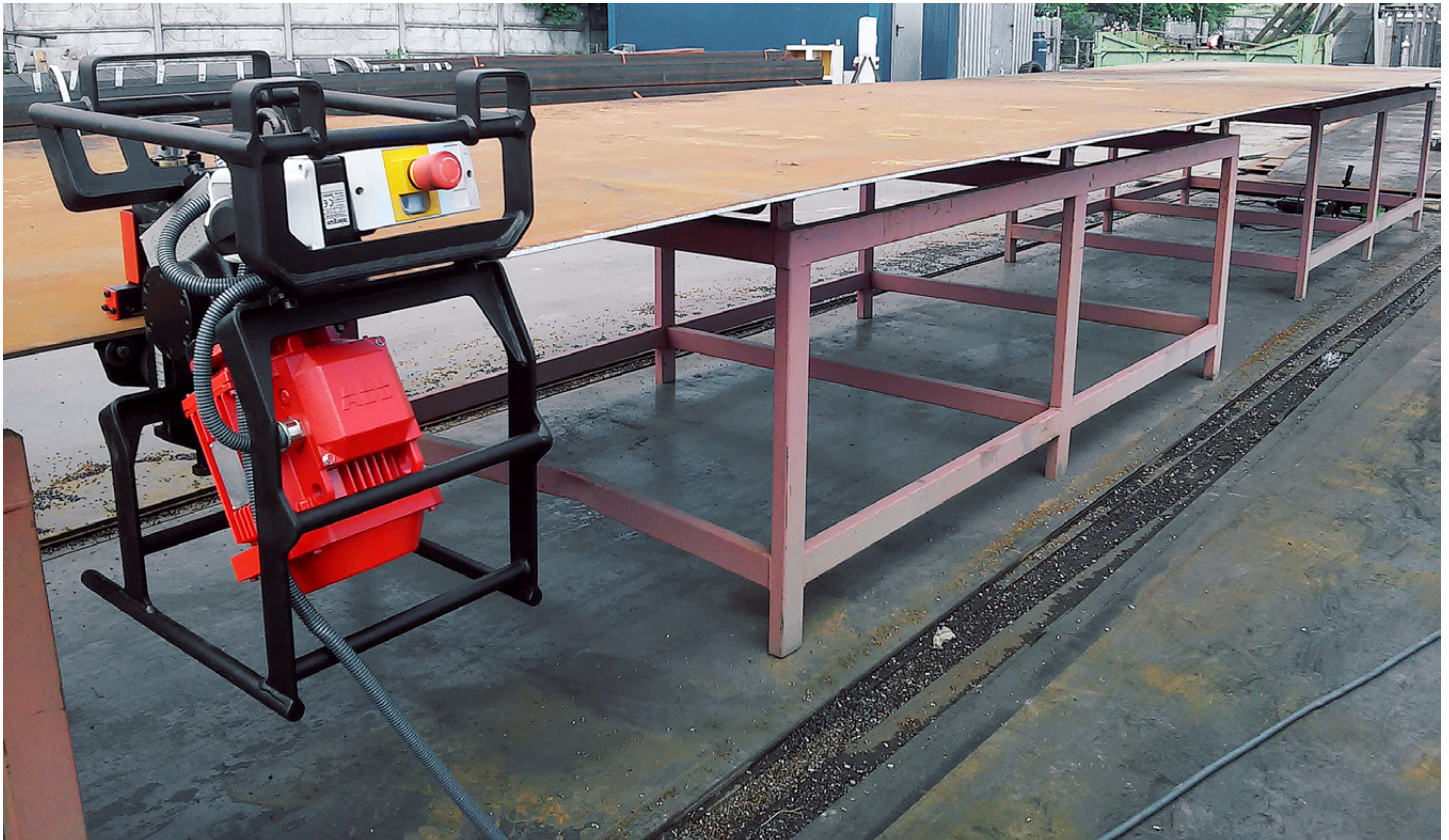
La biseladora ABM-14 avanza automáticamente sobre una chapa
