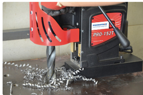
Capacidad de taladrado de hasta 47 mm Máx. recorrido hasta 260 mm
