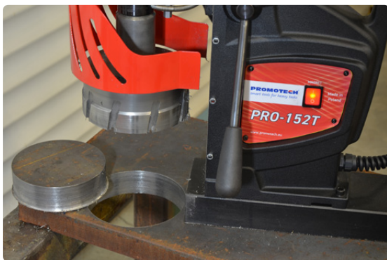
Capacidad de fresado de hasta 150 mm
