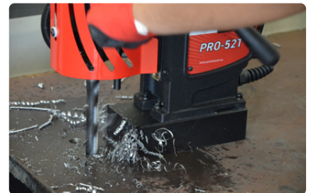
Capacidad de taladrado de hasta 23 mm • Máx. recorrido hasta 190 mm
