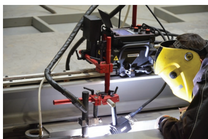
Soldadura TIG de chapa de titanio
