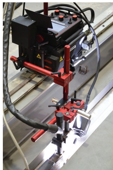
El seguimiento de juntas funciona con y sin oscilación
