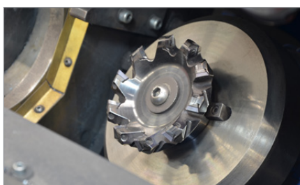
Accès facile à la tête de coupe et aux plaquettes
