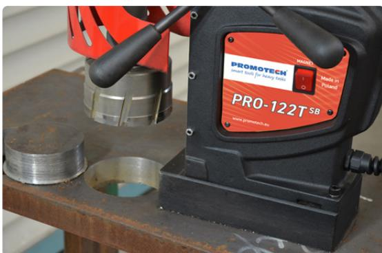
Capacidad de fresado de hasta 120 mm
