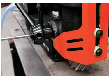
Der Vorschubhebel kann von beiden Seiten fixiert werden
