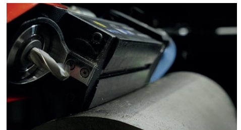
V-förmiger Magnetfuß zum Bohren von Rohren
