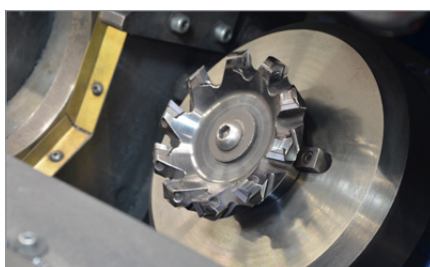
Fácil acceso al cabezal de corte y a las plaquitas
