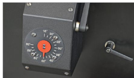
Ajuste preciso del ángulo del bisel
