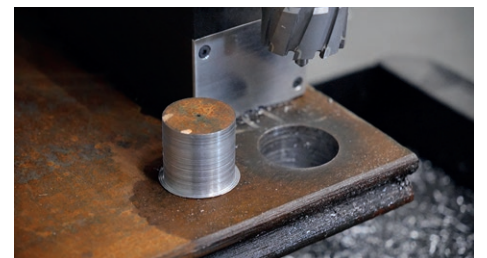
Maximale Schnitttiefe 50 mm
