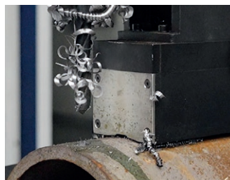
Maximale Bohrleistung 23 mm
