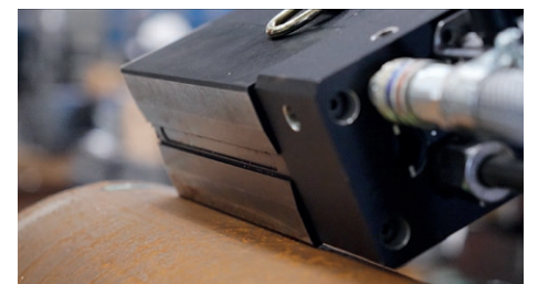
V-förmiger Magnetfuß zum Bohren von Rohren
