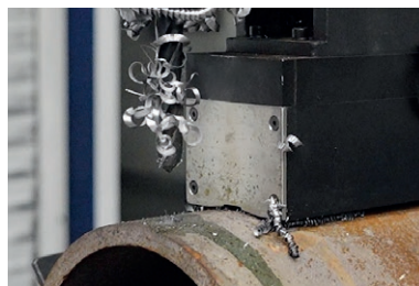
Foratura con punta elicoidale max 23 mm
