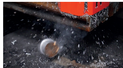
Foratura con frese a corona max 50 mm
