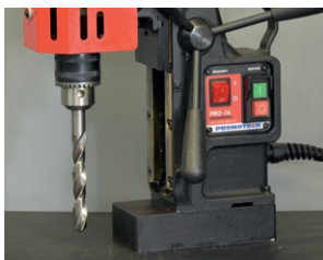
Adaptador 3/4" x 1/2" 20 UNF, Portabrocas 1/2" 20 UNF Broca helicoidal de hasta \Phi 11.8 mm (DIN 338)
