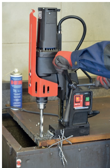
Adaptador 3/4" x 1/2" 20 UNF, Portabrocas 1/2" 20 UNF Broca helicoidal de hasta \Phi 11.8 mm (DIN 338)
