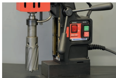
Fresas de metal duro hasta \Phi 45 mm con mandril AMT2-C19/2-3 D.O.C. hasta 75 mm
