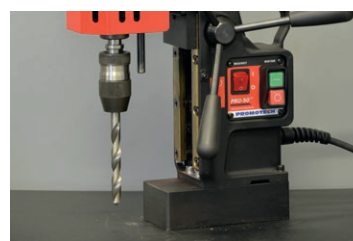
Adaptador MT2 x 1/2" 20 UNF, Portabrocas de cambio rápido 1/2" 20 UNF Broca helicoidal de hasta \Phi 16.0 mm (DIN 338)
