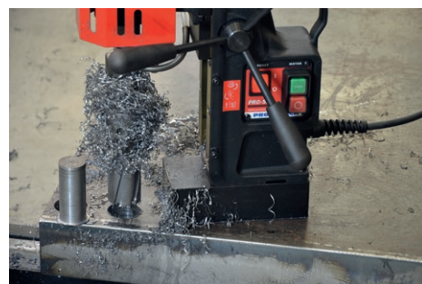
Capacidad de fresado de hasta 45 mm Profundidad de corte de hasta 75 mm - opción
