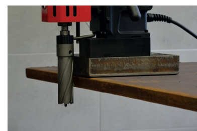
Punto de inicio de taladrado hasta 50 mm por debajo del nivel de una base de taladro con fresa de 100 mm de longitud
