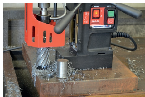
Capacidad de fresado de hasta 50 mm Profundidad de corte de hasta 75 mm - opción
