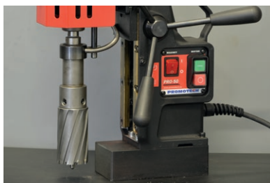
Fresas TCT hasta fi 50 mm con mandril AMT2-C19/2-3 D.O.C. hasta 75 mm
