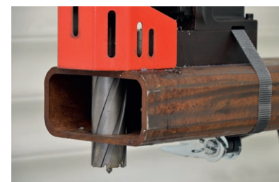
Punto de inicio de fresado hasta 50 mm por debajo del nivel de la base de perforación
