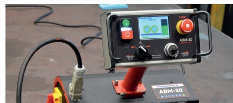
Il pannello di controllo indica la modalità di lavoro reale e fornisce informazioni sulla sicurezza e sulla diagnostica
