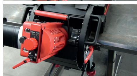
L'innovativo ed ergonomico sistema per la regolazione dell'angolo dello smusso con leva di rilascio, non richiede strumenti aggiuntivi
