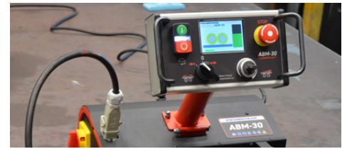
Bedienfeld zeigt den aktuellen Arbeitsmodus an und gibt Sicherheits- und Diagnoseinformationen
