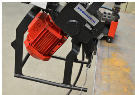
Șanfrenare superioară a tablei
