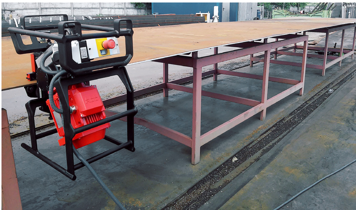
ABM-14 se deplasează automat de-a lungul unei table
