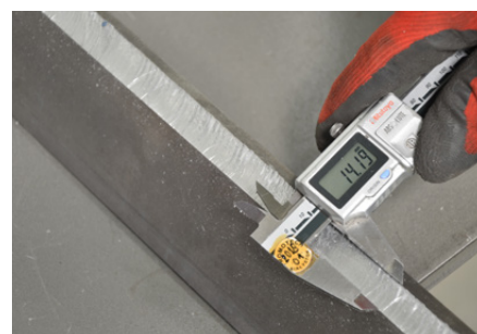
Lățimea maximă a șanfrenului până la 14 mm
