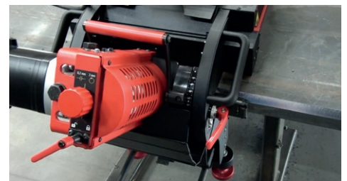
Innovatives und ergonomisches System zur Einstellung des Fasenwinkels mit Entriegelungshebel. Erfordert kein zusätzliches Werkzeug
