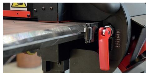
Cómodo ajuste al espesor de la chapa
