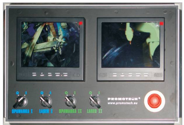
Optionale Ausstattung beinhaltet: Kamerasystem für Schutzgas-/UP-Schweißen und automatische Korrektur der Schweißpistole oder Fernbedienung.
