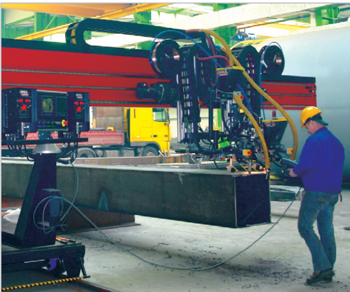
Integration mit verschiedenen Stromquellenreglern - hier: Bearbeitungs-START/-STOPP vom Kreuzmast-Bedienfeld.
