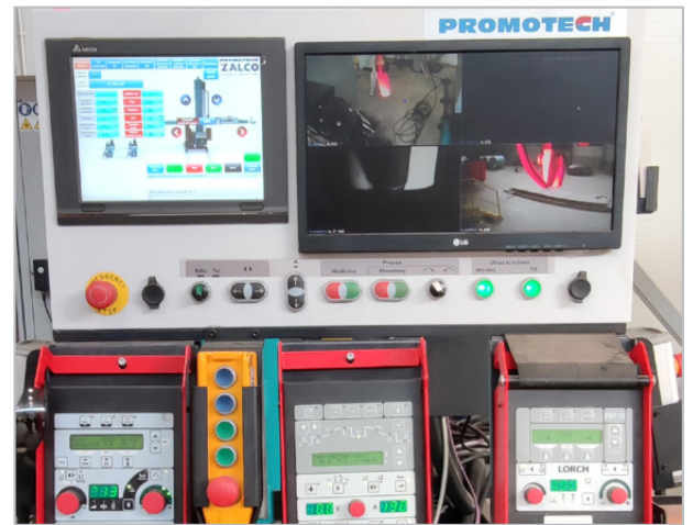
Beispielhafte Ansicht des CB-Bedienfeldes und der integrierten MIG-MAG-Schweißausrüstung von z.B. ESAB, LORCH, ...
