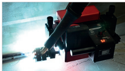
Posizionamento della torcia su ambo i lati
