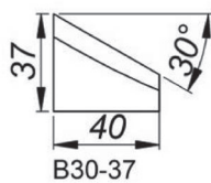
Cuțit de șanfrenare la 30°, Înălțime 37 mm [B30/37] Cod produs: NOZ-000019
