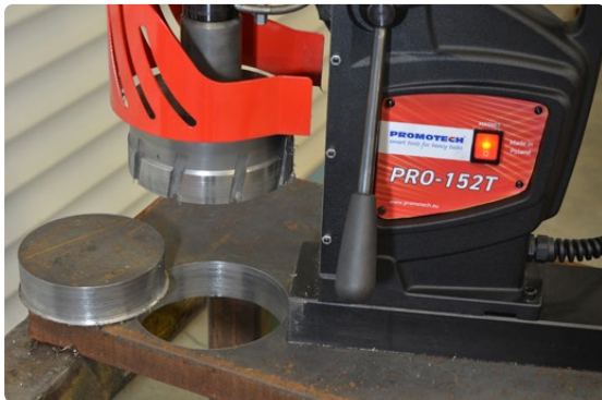
Fräseleistung bis zu 150 mm
