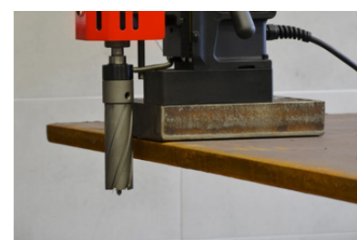
Possibilità di forare fino a 50 mm sotto il livello della lamiera tramite una fresa lunga 100 mm
