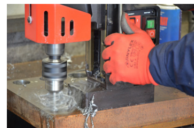
Capacità di foratura fino a 16 mm (0,63") - con punta elicoidale a gambo cilindrico Capacità di foratura fino a 23 mm (0,91") - con punta elicoidale MT2
