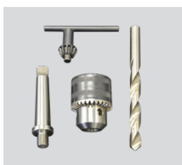
Adattatore MT2 x 1/2" 20 UNF, mandrino per punte elicoidali 1/2" 20 UNF Foratura con punte elicoidali sino a \Phi 16.0 mm (DIN 338)
