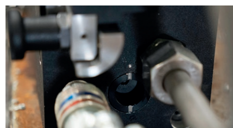
Indicador de nivel de sujeción para mayor seguridad
