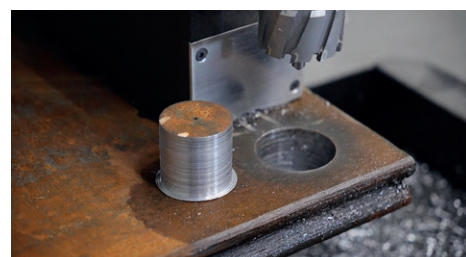
Máx. profundidad de corte 50 mm
