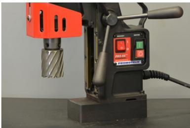
HSS-Fräser bis zu  $\Phi$  40 mm
