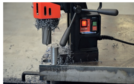
Capacidad de fresado de hasta 45 mm Profundidad de corte de hasta 75 mm
