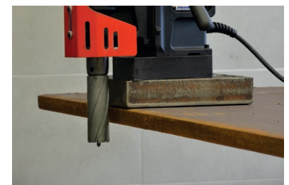
Punto de inicio de taladrado hasta 50 mm por debajo del nivel de una base de taladro con fresa de 100 mm de longitud
