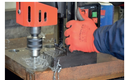
Broca helicoidal de hasta 16 mm - con broca espiral de mango cilíndrico en uso Broca helicoidal de hasta 23 mm - con broca espiral de mango MT2 en uso
