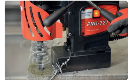
Spiraalboor max 25 mm (1") • Max slag tot 190 mm (7-1/2")
