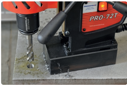
Gewindeschneiden von Durchgangsbohrungen bis M20
