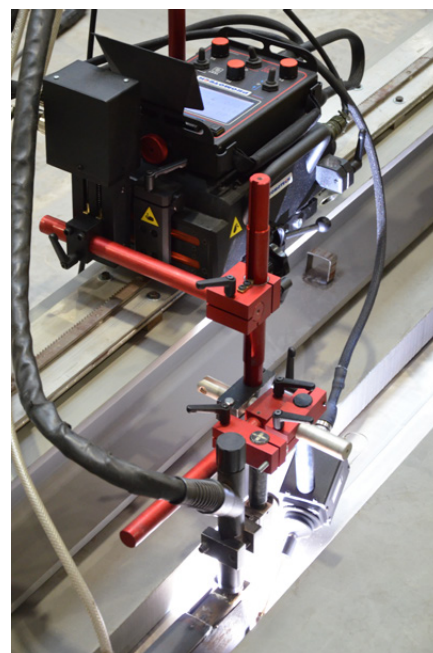
Sømsporing fungerer med og uten oscillasjon
