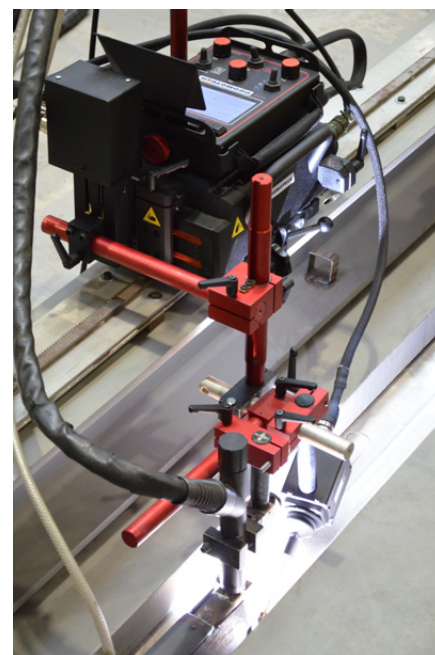
Urmărirea cusăturilor funcționează cu și fără oscilații
