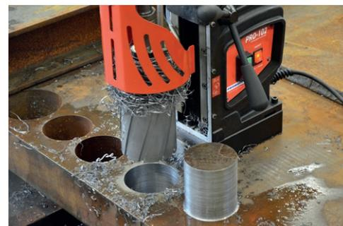
Capacidad de fresado de hasta 100 mm
