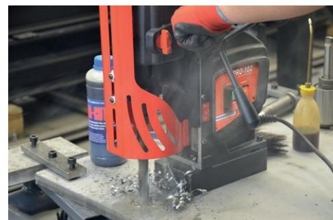
Capacidad de perforación de hasta 31,75 mm
